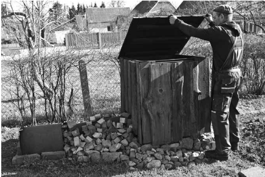
Kalējs Dailonis Jakubovskis sev kūpinātavu uztaisījis no padomju laikos ražota dzelzs atkritumu konteinerā. Ir pietiekami ietilpīgs un kalpo labi, lai zivis un gaļa kūpinātos uz nebedu.
