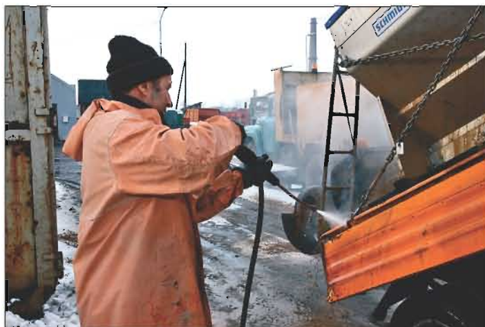
Ikvienas darbdienas noslēgumā tehnika tiek rūpīgi nomazgāta. Tas nepieciešams, lai mašīna «neiesāļtos» pēc sniega šķūrēšanas un ceļu kaisīšanas.
