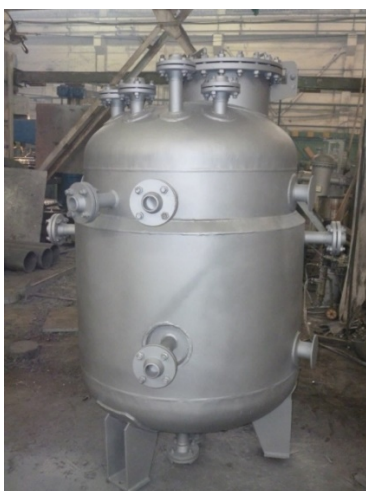
5.15. attēls. Aparāts (reaktors) ar apvalku
