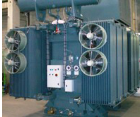
3.23. attēls. Piespiedu gaisa un dabiskā eļļas cirkulācijas sistēma: 1 – tvertne; 2 – magnētqvads ar tinumiem; 3 – kolektori; 4 – ventilatori; 5 – radiatori
