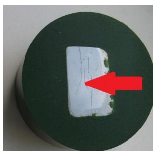
3.9. att. Bojātas sliedes galviņas šablons pēc slīpēšanas.
