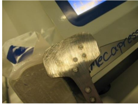
3.8. att. Ķīmiskā sastāva noteikšana, izmantojot “PMI-Master PRO” ķīmisko analizatoru.
