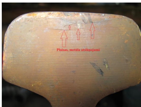
3.5. att. Defekts ar kodu X 10.1, atklāts sliežu ceļa posmā Vecumnieki–Lāčplēsis.
