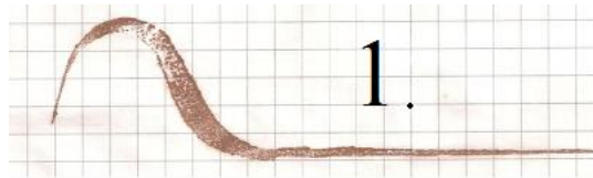
5.1. att. Kravas vilcienu riteņa velšanās virsmas raksturīgā nodiluma atveidojums, kas bieži izplātas VAS “Latvijas dzelzceļš”.
