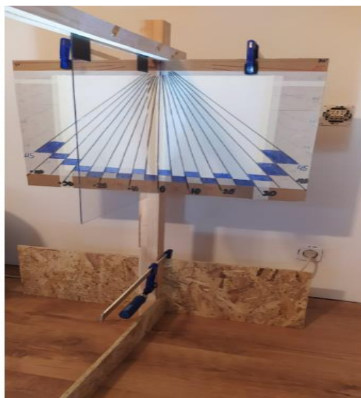
6.6. att. Svārsta kustības izpētes eksperimentālā iekārta.
