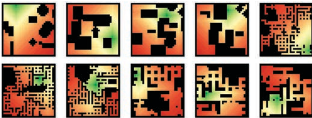
19. att. Sintētisko karšu, kas ģenerētas ar OccupancyMapGenerator un šūnu vērtībām, piemēri, lai sasniegtu pozitīvu terminālu stāvokli (zaļā krāsā — augstākā balvas vērtība, sarkanā — zemākā balvas vērtība).
