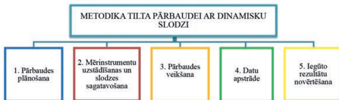
2.1. att. Metodika dinamisko raksturlielumu iegūšanas un novērtēšanai pārbaudei ar dinamisku slodzi.
