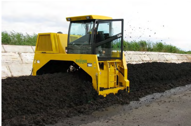
50. attēls. Kompostēšanas stirpu veidošana Liepājas NAI 35
