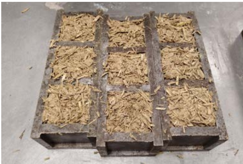
1. attēls. Biokompozītu izgatavošana tērauda veidņos.
