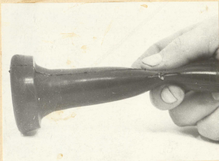
Фиг.1. Отверстие на чупке в месте установки монтажного кольца.
