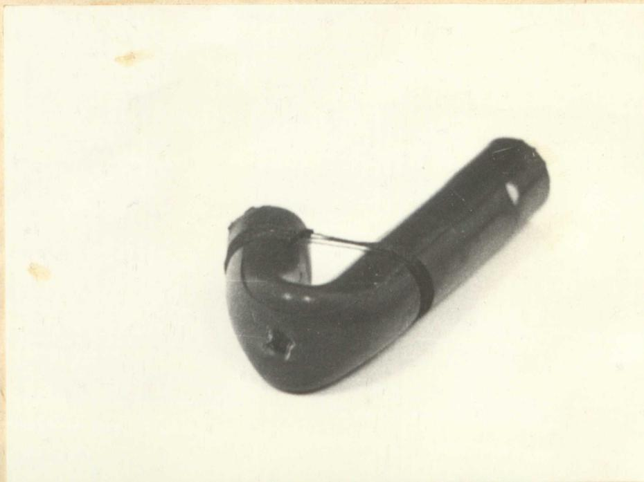
Фиг.6. Характер разрыва молочных трубок.
