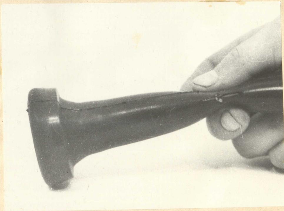
Фиг.3. Характер разрыва сосковой резины на месте установки монтажного кольца.
