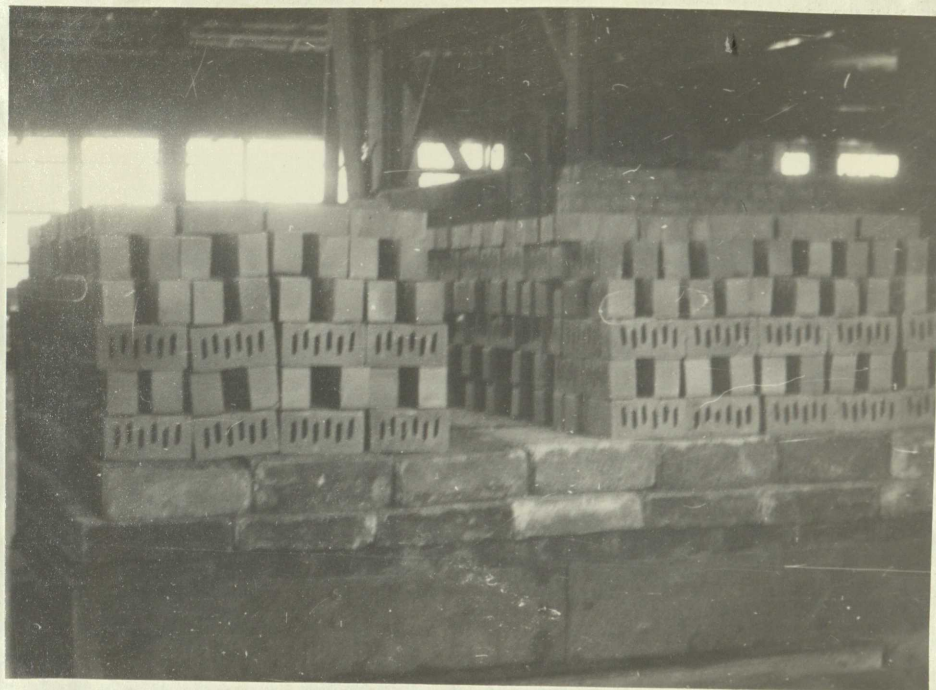
Вагонетка туннельной печи зафутерованная блоками фосфатного бетона Ф-4I перед входом в печь.
