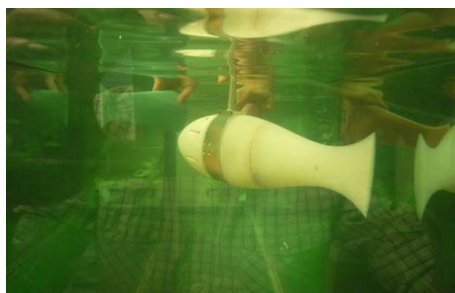
2.4. att. FILOSE zivs robota prototips. [11]
