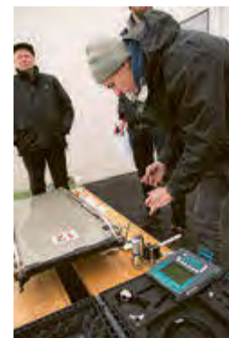
→31. attēls. J. Lungevičs veic skeletona slieču cietības mērījumus Siguldas starta treniņu estakādē. Fonā Jānis Rudzītis (2016).
