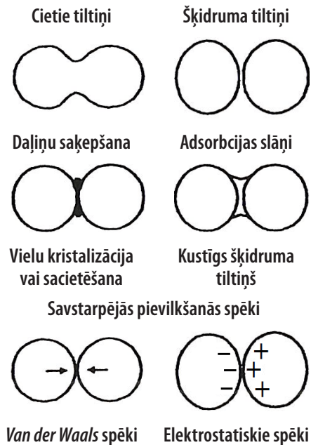
5.3. att. Saistīšanās mehānismi starp cietā materiāla daļiņām.
