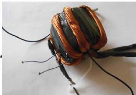
5.20. att. Transformators ar integrētu balansēšanas tinumu.
