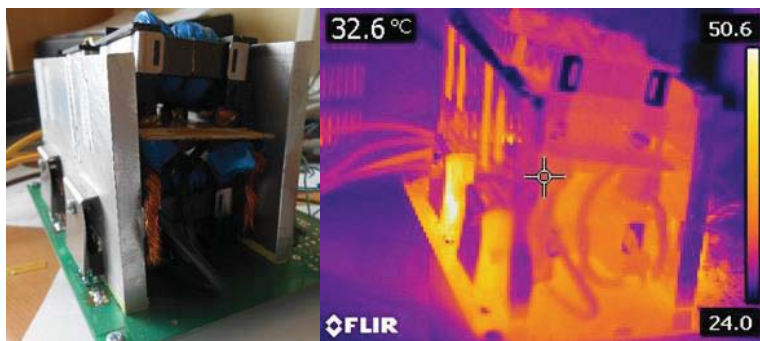
3.14. att. Četrfāžu pārveidotāja prototips un termālā bilde.
