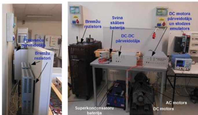
2.7. att. Laboratorijas stends uzkrājēja sistēmas pārbūves komplekta testēšanai.
