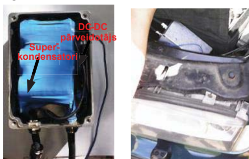
4.3. att. Iekšdedzes dzinēja startēšanas sistēmas prototips; ierīce instalēta vieglajā automašīnā; sprieguma un strāvas mērīšana startēšanas procesa laikā.
