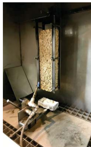
4.7. att. MOC testēšana pēc LVS EN ISO 11925-2.
