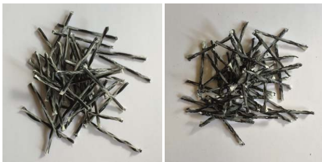
2.9. att. Hibrīdas kompozītās šķiedras: CG1 un GC1 (no kreisās puses).
