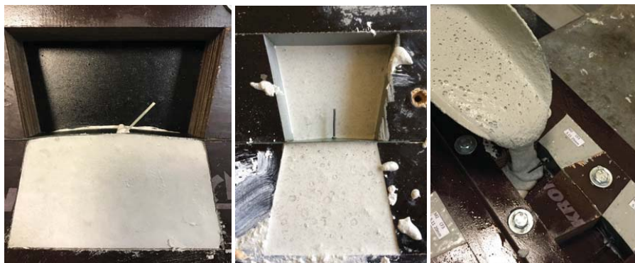
2.13. att. Šķiedras konfigurēšana leņķī, dziļumā un veidņu aizpildīšana ar betonu (no kreisās puses).
