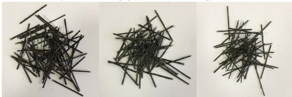
2.3. att. Kompozītās oglekļa šķiedras CF2, CF2-A un CF2-B (no kreisās puses).
