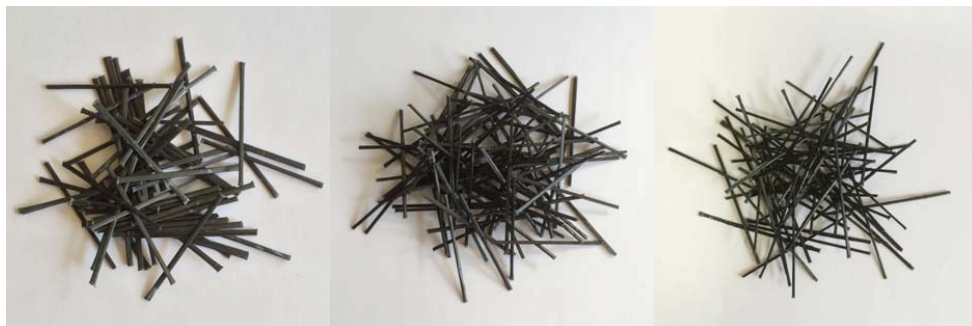
2.2. att. Kompozītās oglekļa šķiedras: CF1, CF1-A un CF1-B (no kreisās puses).
