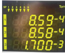
2.4. att. Jonizācijas vakuummetra HPG 400 spiediena mērījums bez argona korekcijas.
