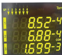
2.3. att. Jonizācijas vakuummētra HPG 400 spiediena mērījums ar argona korekciju.
