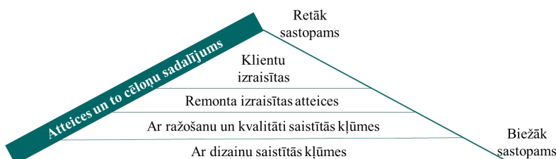
3.2. att. Vispārīgā struktūrā iekārtu atteicēm dažādos elektronikas ierīču lietojumos.
