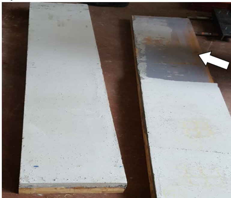
2.2. att. Koka-betona kompozīta parauga izskats pēc sabrukuma.
