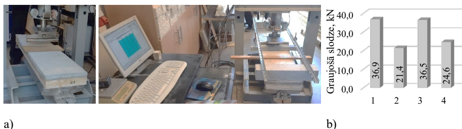
5.8. att. a) Koka-betona plātņu sloģošanas gaita trīs punktu liecē; b) graujošo slodžu vērtības CLT-betona paraugiem ar un bez fibrām, kur 1 un 2 – paraugi bez fibrām; 3 un 4 – paraugi ar fibrām.
