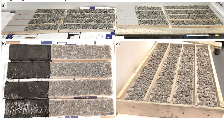
5.1. att. Paraugu izgatavošanas stadijas: a) 16 paraugi pēc līmes nožūšanas; b) parauga gala 40 % apmērā ietīšana plēvē defekta nodrošināšanai; c) paraugu izvietojums veidņos.
