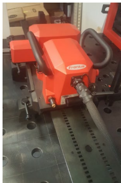
2.2. att. Metināšanas traktors Fronius® FlexTrack 45 Pro .
