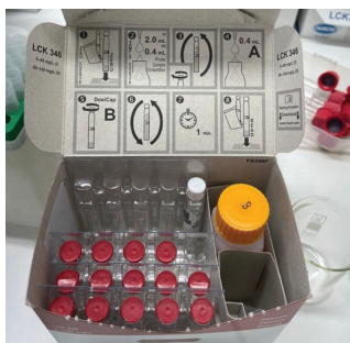
1.attēls. Hach Lange LCK kivešu tests (LCK 346 – Fenola saturs noteikšana)
