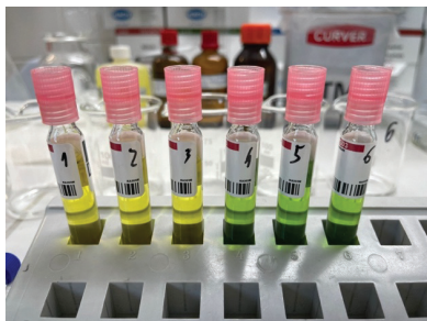
9. attēls. Ķīmiska skābekļa patēriņa testēšana paraugā
