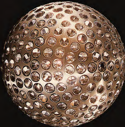
Ģeodēziskais pavadonis LAGEOS 1 ir masīva lode, ko klāj lāzeratstarotāji
