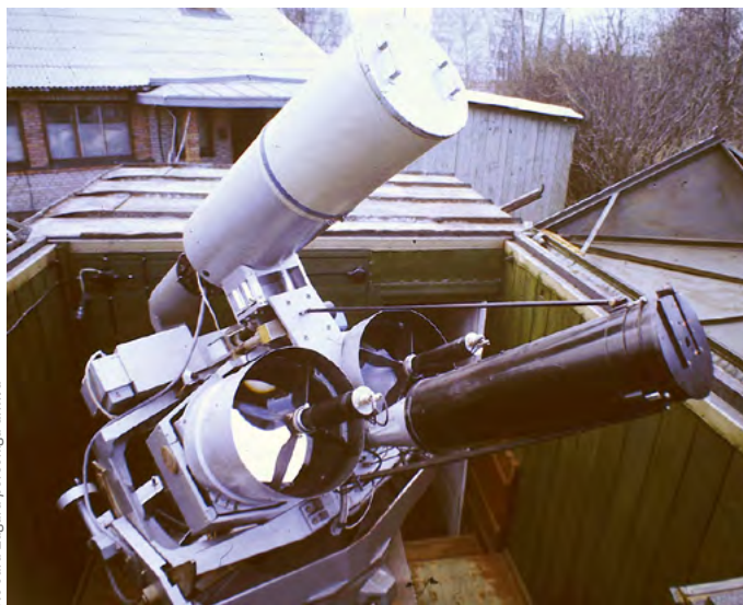
Lāzera tālmērs LD-2 Rīgā. Redzams lāzera stara raidītājs (melnā caurule), divi vienādi objektīvi-uztvērēji un teleskops-gids (augšā)
