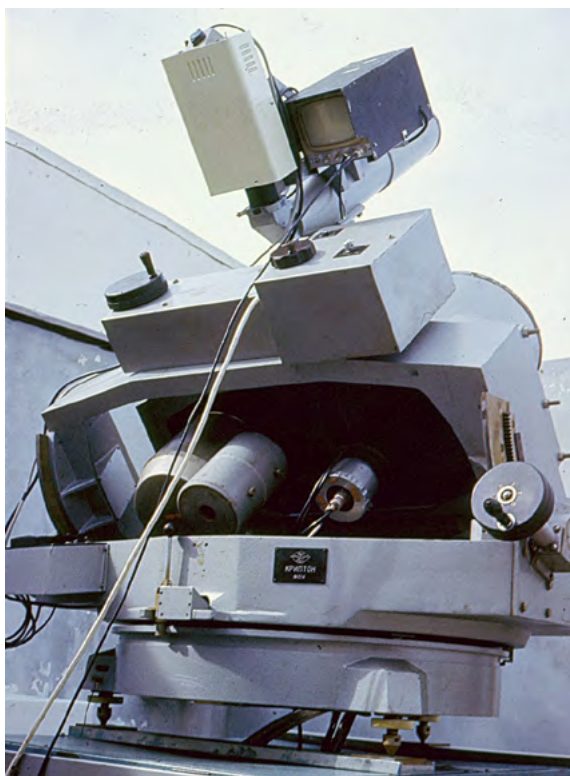
Lāzera tālmērs LD-2 Indijā, skats no aizmugures. Pie teleskopa-gida pierīkota televīzijas kamera
