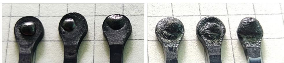
2. att. Atjaunotie elektrodi, izmantojot lāzeruzkausēšanu ar stiepli (kreisajā pusē) un ar pulveri (labajā pusē).
