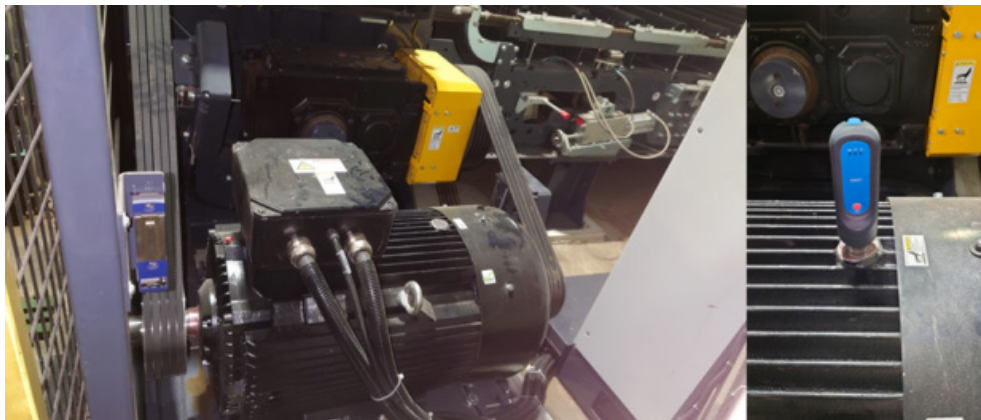
1. att. Lenze piedziņas elektromotors ar uzstādītu “ SKF Enlight ” vibrācijas sensoru.
