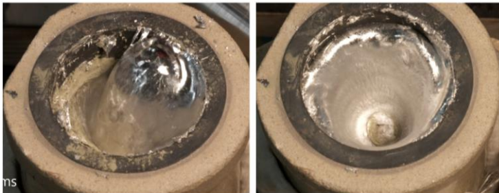
Attēls 12 Pusšķidra (~610 °C) A360 sakausējuma maisīšana – intensīvas virsmas deformācijas, ko rada PM maisītājs tīģeļa sēnā (pa kreisi), virpuļveida plūsma, ko rada maisītājs zem tīģeļa (pa labi).
