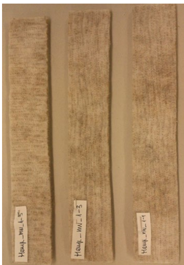
3.1. att. Hemp_nw-1 NM parauga sloksnes.
