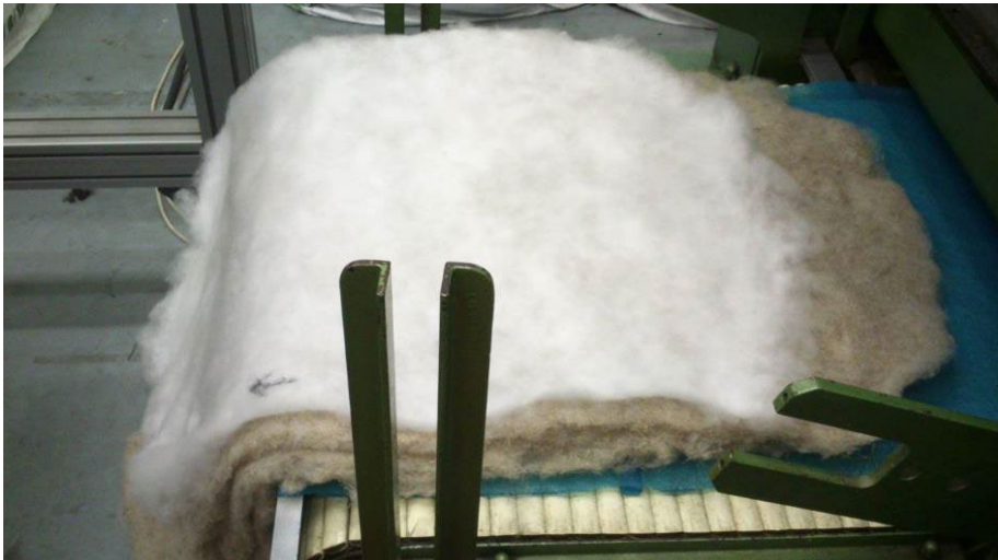
2.9. att. Visu šķiedru klājuma kārtu sagatavošana otrajai cauradatošanai.
