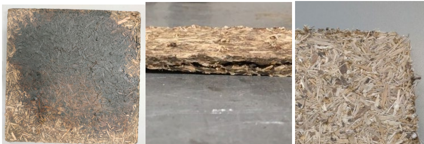
2.2. att. Plātnes, kas izgatavotas pie ekstremālām neatkarīgo mainīgo vērtībām.
