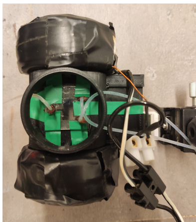
(b) Spoles ar turētāju eksperimentiem ar vertikālā magnētiskā laukā, kas ir paralēls mikrofluidikas čipam.
