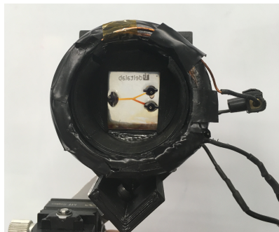
(a) Spoles ar turētāju eksperimentiem ar horizontālā magnētiskā laukā, kas ir perpendikulārs mikrofluidikas čipam.
