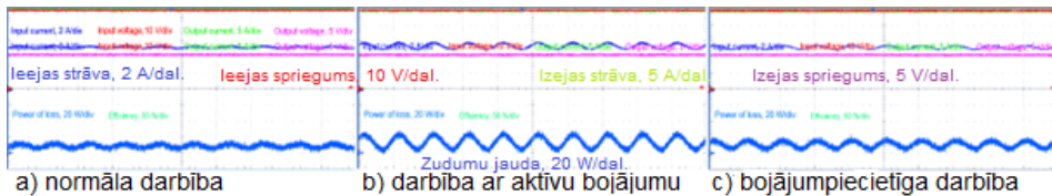
3.6. att. Izmērīto spriegumu un strāvu salīdzinājums pārveidotāja ieejas un izejas pieslēgvietās dažādos darbības režīmos.
