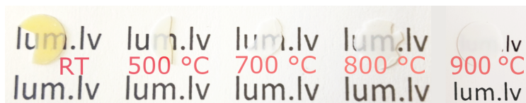
Attēls 4.4: Presēta keramika bez atkarsēšanas (RT) un atkarsētās keramikas 500°C, 700°C, 800°C un 900°C temperatūrā (pa labi).
