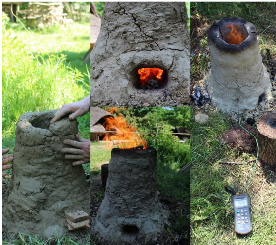
20. att. Dabīgās vilkmes krāsns izbūve un testēšana Velsenā, 2017. g. maijā (foto: A. Tomsons).
