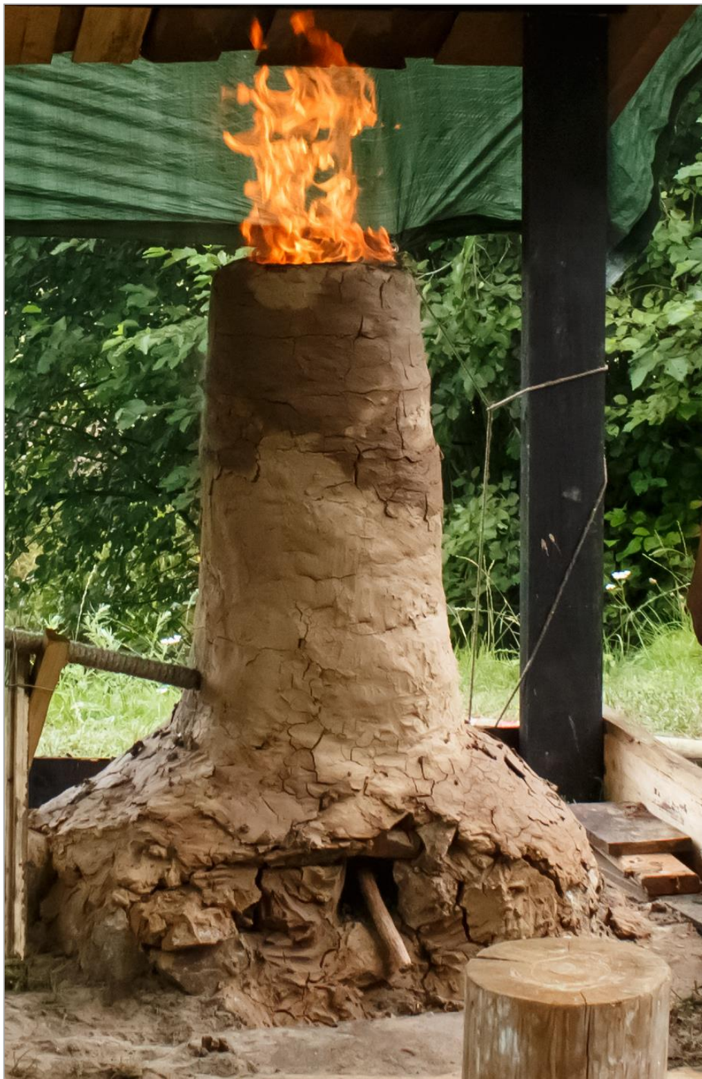
19. att. Dzelzs redukcijas krāsns Ventspils Piejūras brīvdabas muzejā 2016. g. (foto: A. Vijups).
