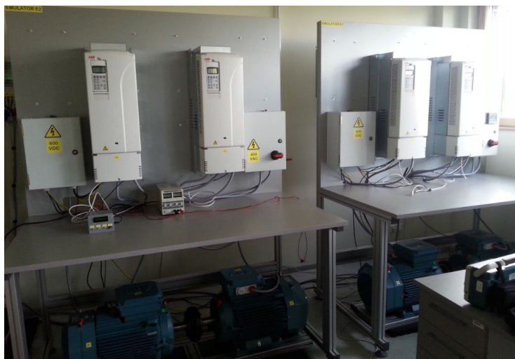
3.6. att. Izstrādātie DC jaudas plūsmas emulatori RTU AREUS demo laboratorijā.
