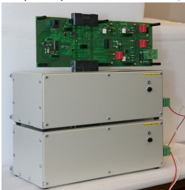
2.15. att. Praktiski realizēts modulārs industriālo robotu līdzstrāvas posmu starsavienojumu risinājums.
