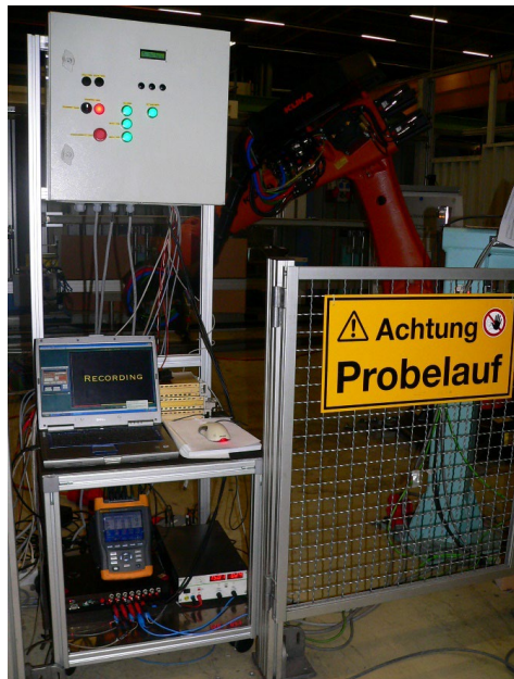
2.8. att. Līdzstrāvas starpsavienojuma elektrisko parametru datu ierakstīšanas un maiņstrāvas jaudas analizatora pieslēgums.
