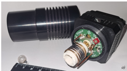
2.1. att. Darbā izmantotie gaismas avoti kopā ar to ierosmes ģeneratoriem: a) arsēna lampa; b) dzīvsudraba kapilārā lampa.
