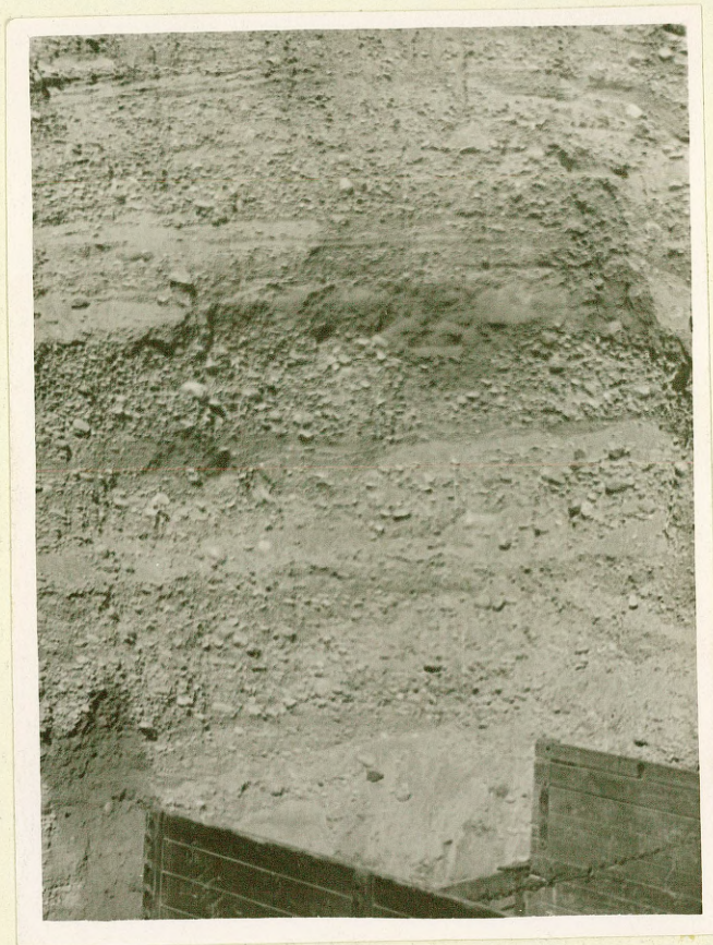
Фото 6. Забой песчано-гравийного карьера у хут.Одре ( 10 км восточнее г.Талси). Видна слоистость близкая к горизонтальной.
