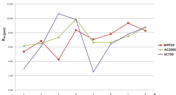
12. att. 304. markas nerūsējošā tērauda, kas apvirpots ar dažāda materiāla instrumentu, virsmas vidējā raupjuma vērtību grafiskais attēlojums.
