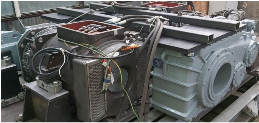
5.8. att. DRB testēšanas stends ar savstarpēju slodzes funkciju.
