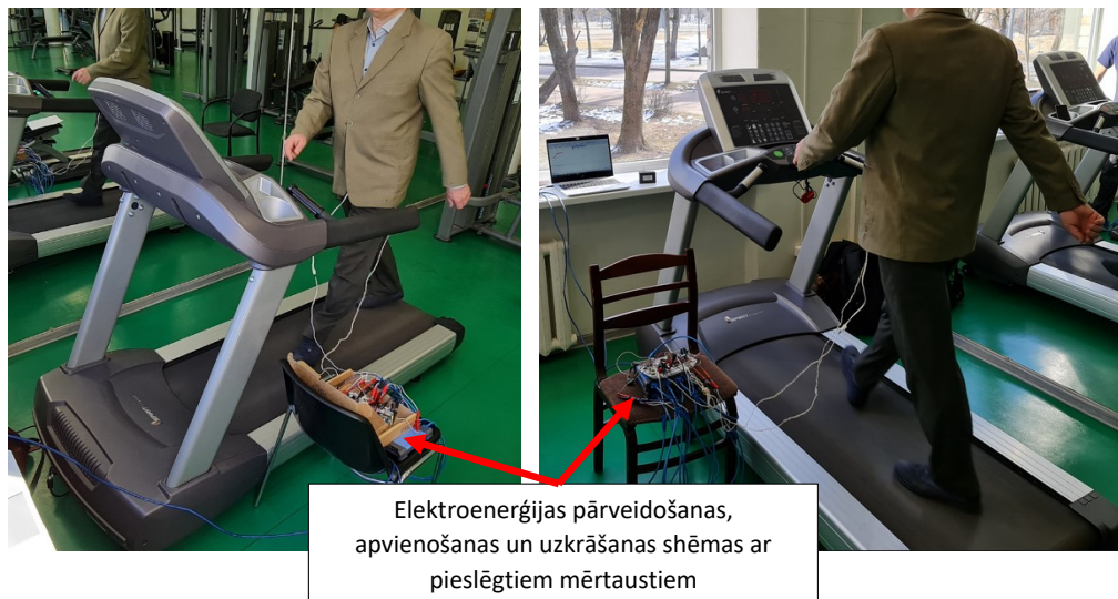
5.10. att. Dažādo enerģijas ievācēju kopējie mērījumi uz elektriskā skrejceļa ar fiksētu ātrumu.
