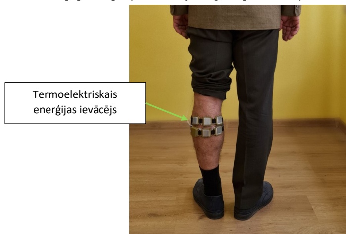
5.8. att. Termoelektriskā enerģijas ievācēja izvietojums ap apakšstilbu.
