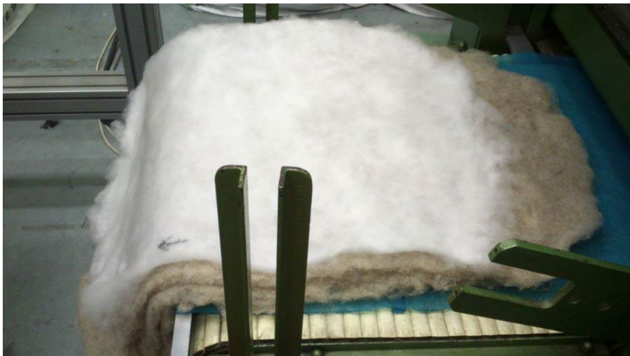
2.17. att. Visu šķiedru klājuma kārtu sagatavošana otrajai cauradatošanai.
