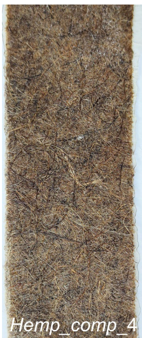
3.22. att. Hemp_comp kompozīta paraugu: a) Hemp_comp_1 ; b) Hemp_comp_2 ; c) Hemp_comp_3 ; d) Hemp_comp_4 un e) Hemp_comp_5 sloksnes.
