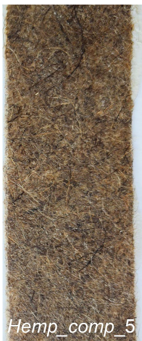
3.22. att. Hemp_comp kompozīta paraugu: a) Hemp_comp_1 ; b) Hemp_comp_2 ; c) Hemp_comp_3 ; d) Hemp_comp_4 un e) Hemp_comp_5 sloksnes.
