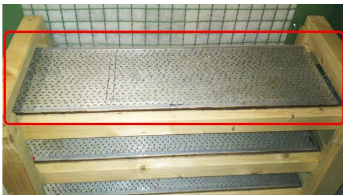
2.14. att. GROZ-BECKERT adatas sakārtotas adatu plātnē.
