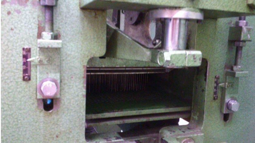
2.15. att. DILO LBM6 cauradatošanas mašīnas sānskats ar redzamu adatu plātņi un apakšējās un augšējās plātnes regulēšanas mehānismiem.
