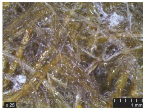
3.33. att. Flax_comp virsma ar PLA šķiedru defektiem.
