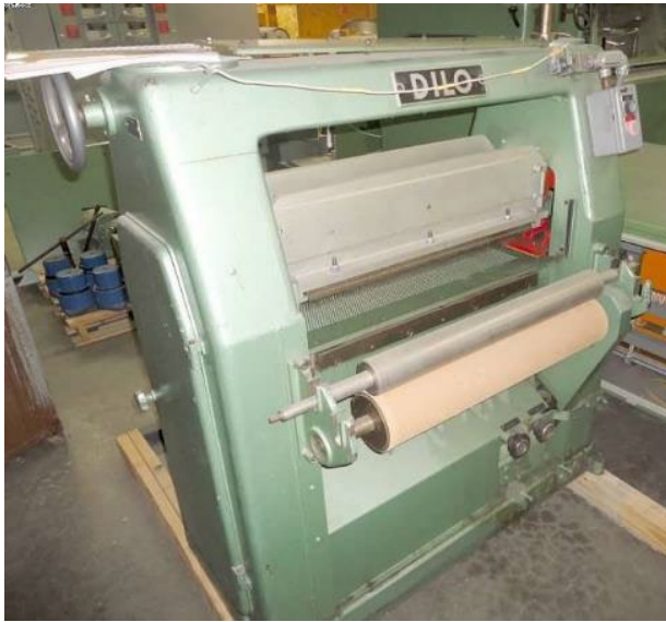
2.10. att. Laboratorijas cauradatošanas iekārta ar vienu vertikālas darbības adatu galda dēli DILLO LBM 6 [103].
