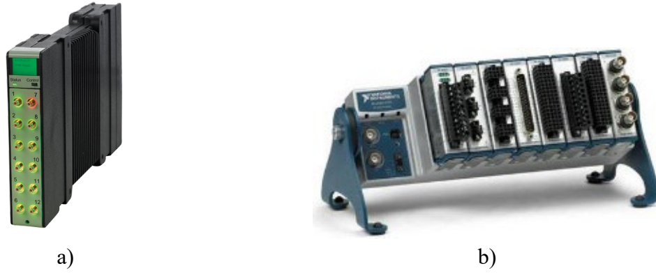
Fig. 2.10. DAQ devices: a) LAN-XI Type 3053 ; b) CompactDAQ .
