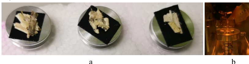
2.9. att. a – uz pamatnēm pielīmēti paraugi; b – iekārta paraugu pārklāšanai ar oglekļa pārklājumu.
