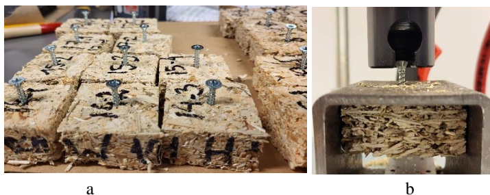
2.21. att.: a – paraugi skrūvju aksiālajā testā; b – skrūvju aksiālā izraušana.
