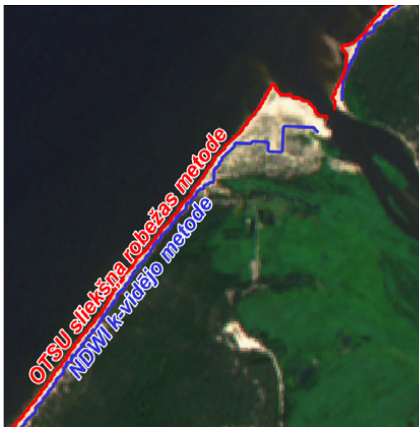
12. attēls. Divu metožu vektorizēto līniju salīdzinājums 2022. gada 21. jūlija satelītainā pie Gaujas ietekas jūrā. Izteikti redzamas atšķirības klasifikācijas algoritma rezultātos – NDWI k-vidējo klasifikācija vietā aprēķina ūdens robežu iekšzemē, tuvāk veģetācijas robežai
