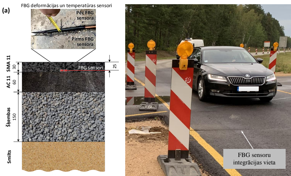
3.2. attēls FBG sensora integrācija autoceļa seguma virskārtas slānī (a) un (b) lokācijā.
