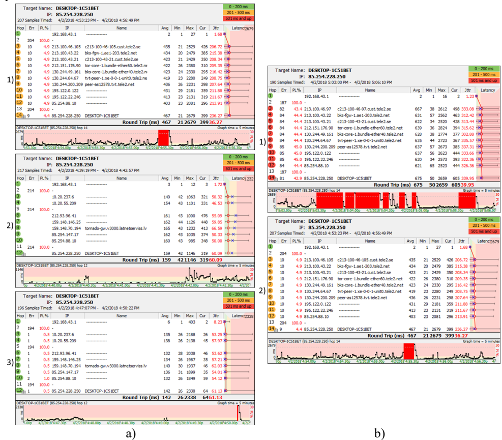
3.18. att. Laika aizkaves mērījumu rezultāti otrajam eksperimentam LMT (a) un Tele2 (b) MST: 1) 2G ( EDGE ); 2) 3G ( HSPA ); 3) 4G ( LTE-A ).
