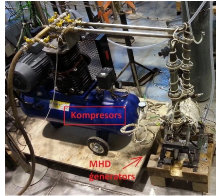
4.10. att. Izstrādātais kompresora stends MHD ģenerators neatkarīgajiem testiem: a) uzbūves shēma; b) eksperimentālā stenda foto
