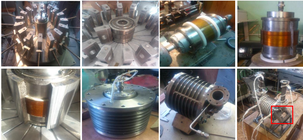
1.12. att. MHD ģenerators izgatavošana un salikšanas secība
