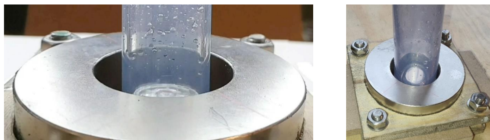
4.29. att. Magnēta novietojums attiecībā pret šķidruma virsmu
