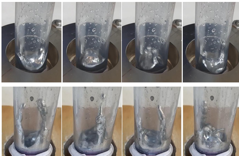
4.30 att. InGaSn brīvās virsmas elektromagnētiskās stabilizācijas eksperiments pie 20 Hz: a) Ar pieliktu magnētisko lauku – augšā; b) Bez magnētiskā lauka - apakšā
