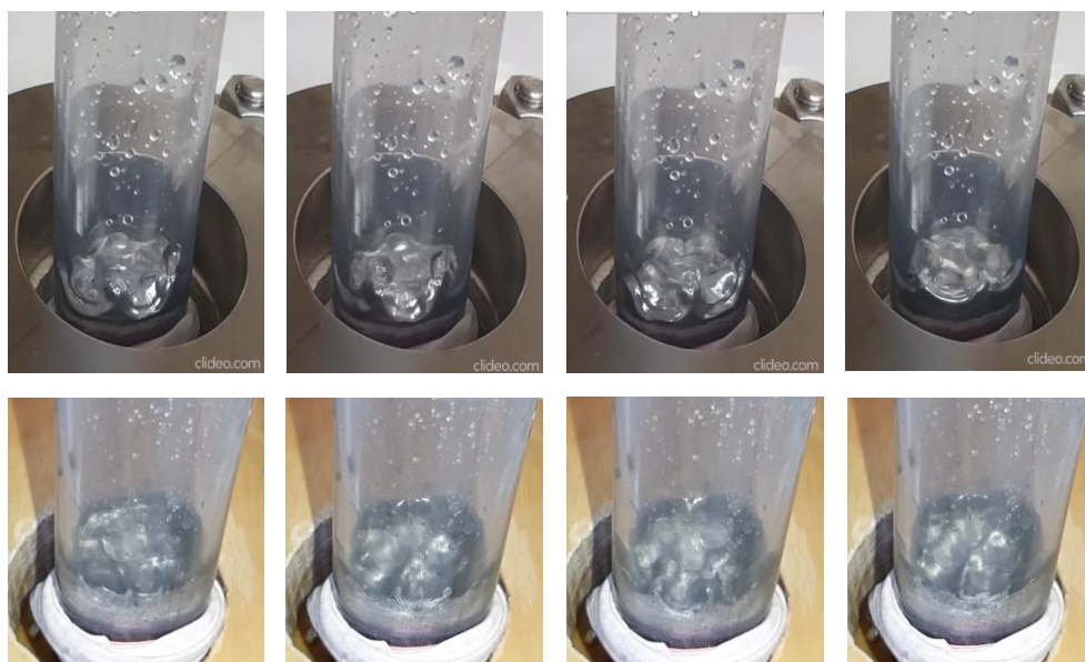
4.31. att. InGaSn brīvās virsmas elektromagnētiskās stabilizācijas eksperiments pie 40 Hz: a) Ar pieliktu magnētisko lauku – augšā; b) Bez magnētiskā lauka - apakšā
