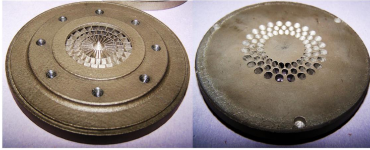
1.10. att. Ar 3D printēšanas tehnoloģiju izgatavotie mašīnas malējie titāna atloki ar apakškanālu pāreju no kantainas formas uz apaļu – detaļa parādīta kā no vienas, tā otras puses
