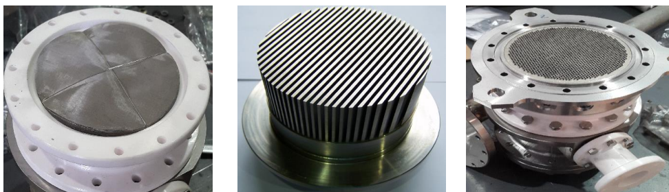
1.3. att. Reģenerators ar cirkonija oksīda keramikas apvalku (pa kreisi), karstais siltummainis (vidū) un samontēts TAC dzinējs ar auksto siltummaini augšdaļā (pa labi)
