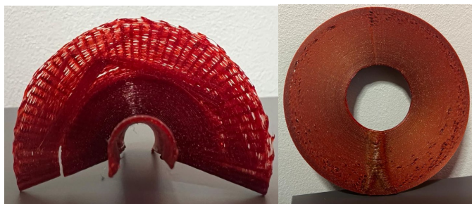
5.11. att. Cilindriskās drukas piemērs bez plūsmas regulēšanas un ar manuālo procentu.
