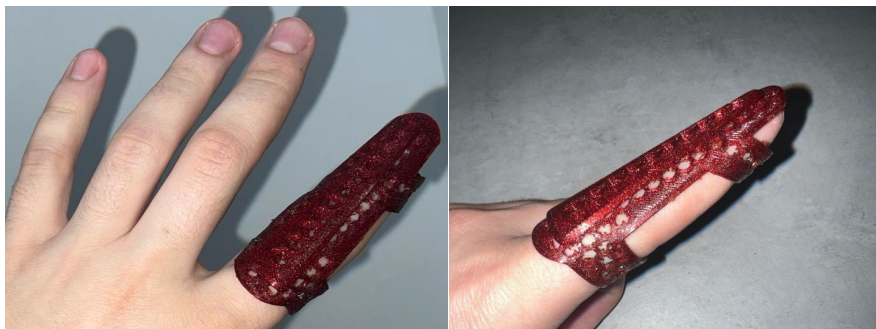
6.10. att. Piecasu drukāts pirksta ortozes piemērs ar 45° slāņa aizpildījumu.
