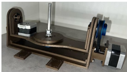
6.8. att. Papildu A un B asu drukas galda mehānisms no PA12 neilona materiāla.
