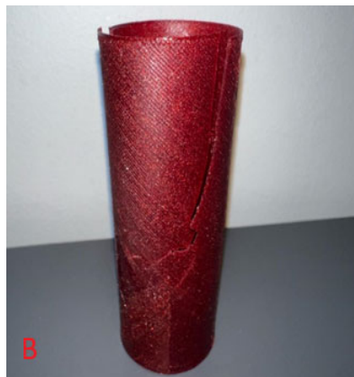
5.36.att. Lieces testa paraugu sabrukšanas veids. (A) Horizontālo slāņu paraugs. (B) Cilindriskas metodes paraugs.
