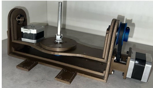
6.8.att. Papildu A un B asu drukas galda mehānisms no PA12 neilona materiālā.
