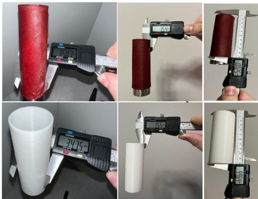
5.33.att. PLA materiāla drukāto paraugu izmēru salīdzināšanas rezultāti.
