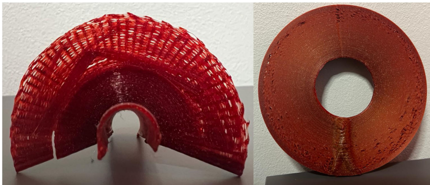
5.11.att. Cilindriskas drukas piemērs bez plūsmas regulēšanas un ar manuālo procentu.
