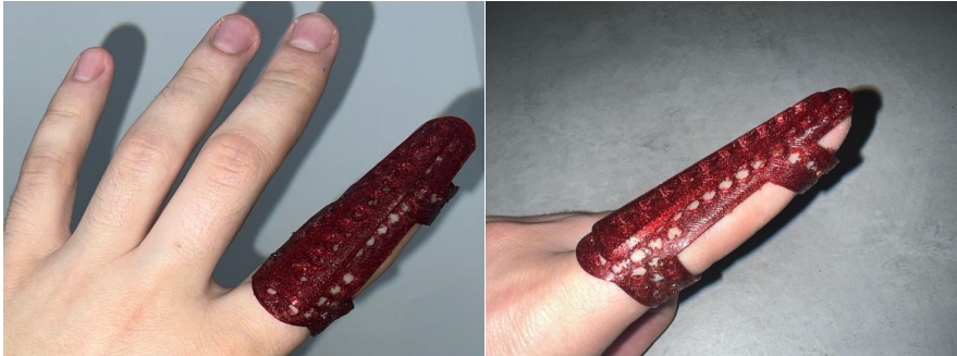
6.10.att. 5 asu drukāts pirksta ortozes piemērs ar 45° slāņa aizpildījumu.
