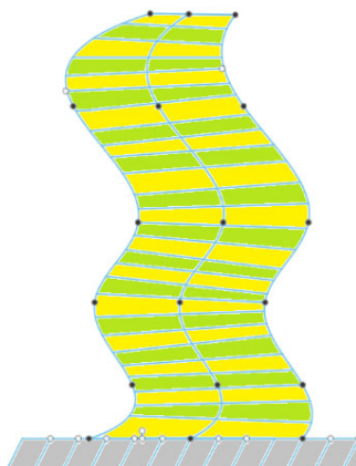
3.8.att. Ar pārkares struktūras segmentācijas metodi sagriezts modelis [37].
