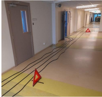
2.47. att. Līdzstrāvas tīkla fizikālais modelis ar izritinātiem kabeļiem.
