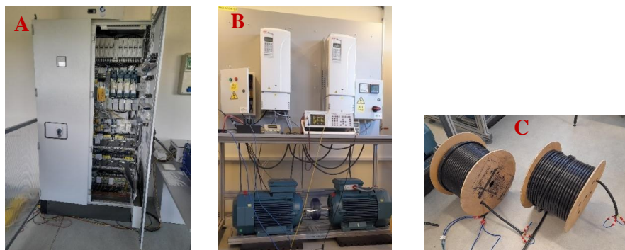
2.45. att. A – aktīvais taisngriezis; B – dzinēju stends un jaudas analizators uz galda; C – saritināti kabeļi.
