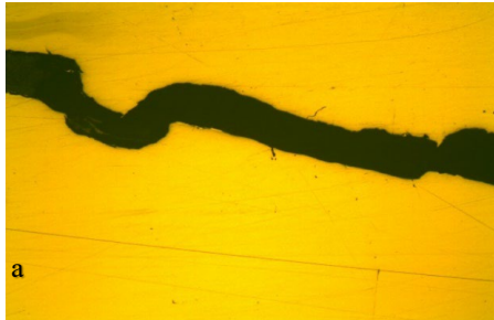
3.139. att. 13. paraugs. pētāmo bultskrūves mikrostruktūra, palielinājums a – \times 50 ; b – \times 200 .
