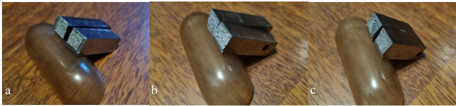
3.126. att. Paraugu sagraušanas veids pēc izmēģinājumiem: a – 7. paraugs; b – 8. paraugs; c – 9. paraugs.
