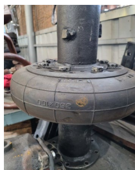
1.8. att. Gumijas korda sajūgs DRIA sērijas dīzeļvilcieniem: a – sajūgs 580 x 130 mm; b – sajūgs 360 x 100 mm.
