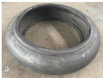
1.7. att. Gumijas korda sajūgs dīzeļlokomotīvēm ČME-3: a – kopskats; b – novietošanas vieta.
