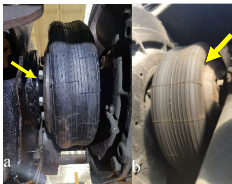
3.7. att. Nepareizi sajūgu regulēšanas piemēri: a - radiāla izmēru neievērošana; b –aksiālo izmēru neievērošana.
