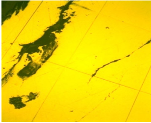
3.154 att. Metalogrāfiska analīze pēc 730 sitieniem ar spēku 40 000 N palielinājums – \times 200 : a – 29. paraugs; b – 30. paraugs.
