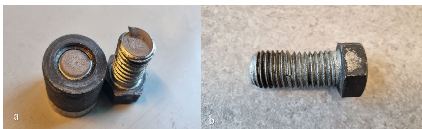
3.125. att. 6. paraugs: a - nogurumu sagraušana; b - kopskats pēc pārrāvuma.
