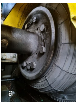
1.8. att. Gumijas korda sajūgs DRIA sērijas dīzeļvilcieniem: a – sajūgs 580 x 130 mm; b – sajūgs 360 x 100 mm.
