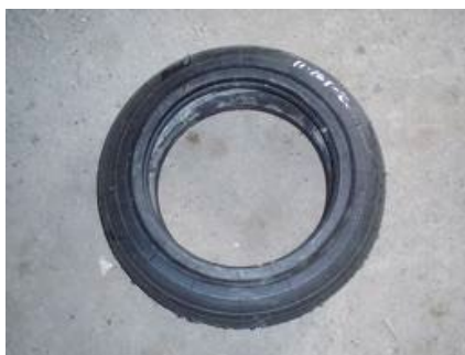
1.6. att. Gumijas korda sajūgs 500 \times 130 mm dīzeļlokomotīvēm TGM4 , TEM2 , TGM6 .
