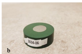
3.134. att. Paraugu sagatavošana metalogrāfiskai analīzei: a – 10. paraugs; b – 11. paraugs.
