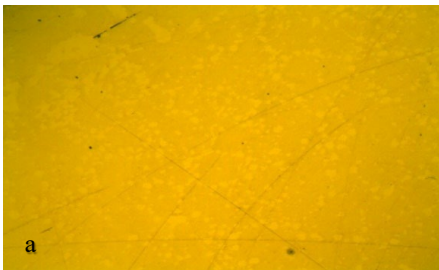
3.140. att. 14. paraugs pētāmo bultskrūves mikrostruktūra, palielinājums a – \times 50 ; b – \times 200 .
