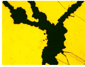
3.157. att. Metalogrāfiska analīze pēc 150 sitieniem ar spēku 100 000 N palielinājums \times 200 : a – 35. paraugs; b – 36. paraugs.
