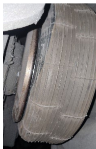
1.14. att. Gumijas korda sajūga 8. bultskrūvju sagraušana.
