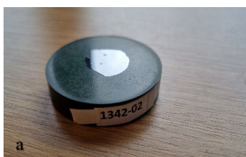
3.134. att. Paraugu sagatavošana metalogrāfiskai analīzei: a – 10. paraugs; b – 11. paraugs.
