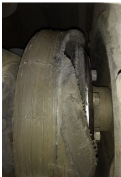
1.13. att. Korda sajūga bojājums pusdiska izmēšanas rezultātā.
