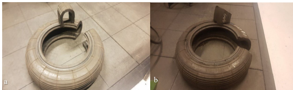
3.5. att. Gumijas korda sajūgu sagatavošana mērījumiem: a- 1 paraugs; b – 2 paraugs.
