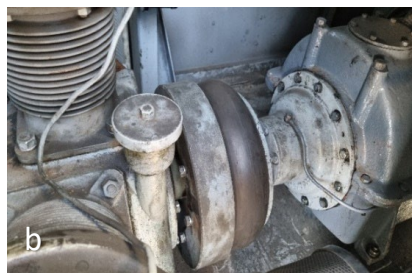
1.7. att. Gumijas korda sajūgs dīzeļlokomotīvēm ČME-3: a – kopskats; b – novietošanas vieta.
