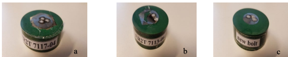
3.133. att. Bultskrūvju ķīmiskā sastāva noteikšana.
