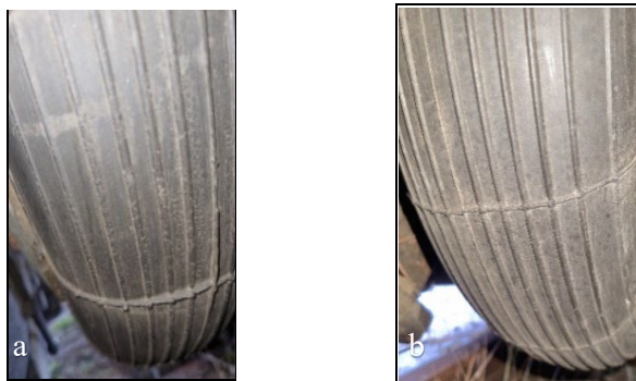
3.2. att. Sajūga termiska novecošana: a- skats no kreisajā pusē; b – skats no labajā pusē.
